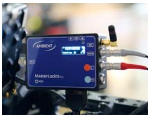
CP.3XD mit seitlichem Metadaten-Anschluss. Der MasterLockitPlus sammelt alle Metadaten von Kamera und Objektiv und gibt sie ans Ambient Communication Network ACN weiter. ©HDM Stuttgart
