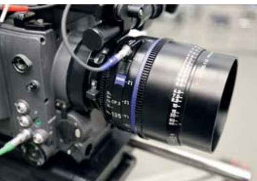
CP.3XD mit seitlichem Metadaten-Anschluss. Der MasterLockitPlus sammelt alle Metadaten von Kamera und Objektiv und gibt sie ans Ambient Communication Network ACN weiter. ©HDM Stuttgart
