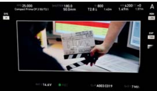
Kamera- und objektivbezogene Metadaten werden im SDI-Signal mit übertragen und können in der Videoausspiegelung mit angezeigt werden.
